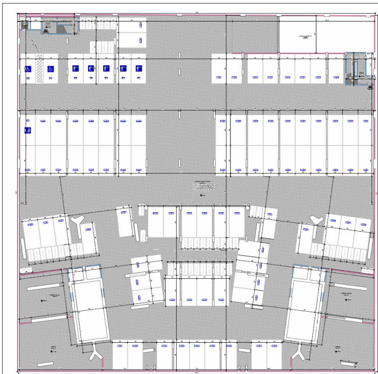
Figura 2. Detalhamento do projeto do subsolo demonstrando o atendimento integral ao recuo frontal previsto na legislação municipal.
